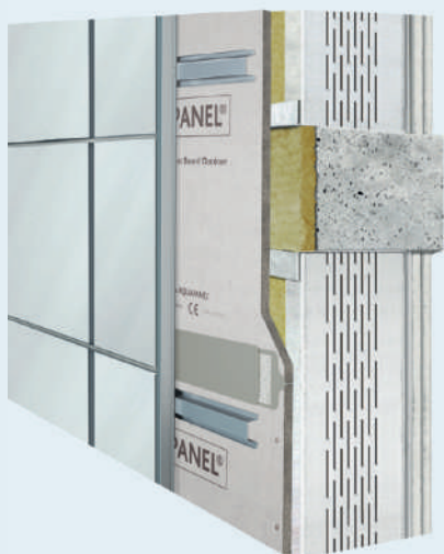
Облицовка алюминиевыми кассетами
