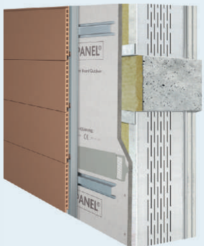
Облицовка терракотовой плиткой
